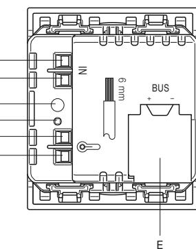
A: Ingresso digitale privo di potenziale (SELV) con funzionalità configurabile • Potential-free digital input (SELV) with configurable function
